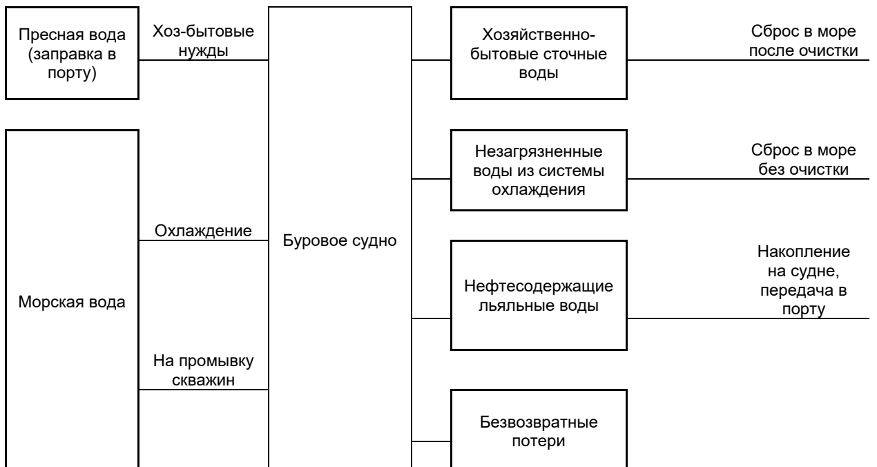
Рисунок 7.2-2. Схема баланса водопотребления-водоотведения на судне, выполняющем геотехнические работы
