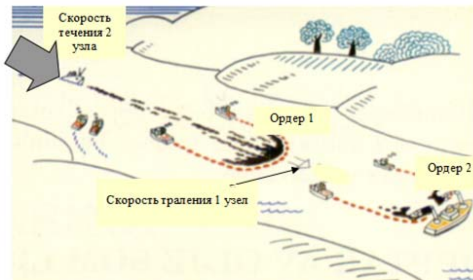
Рисунок Ж.10 Траление и сбор разлитой нефти при сильном течении
