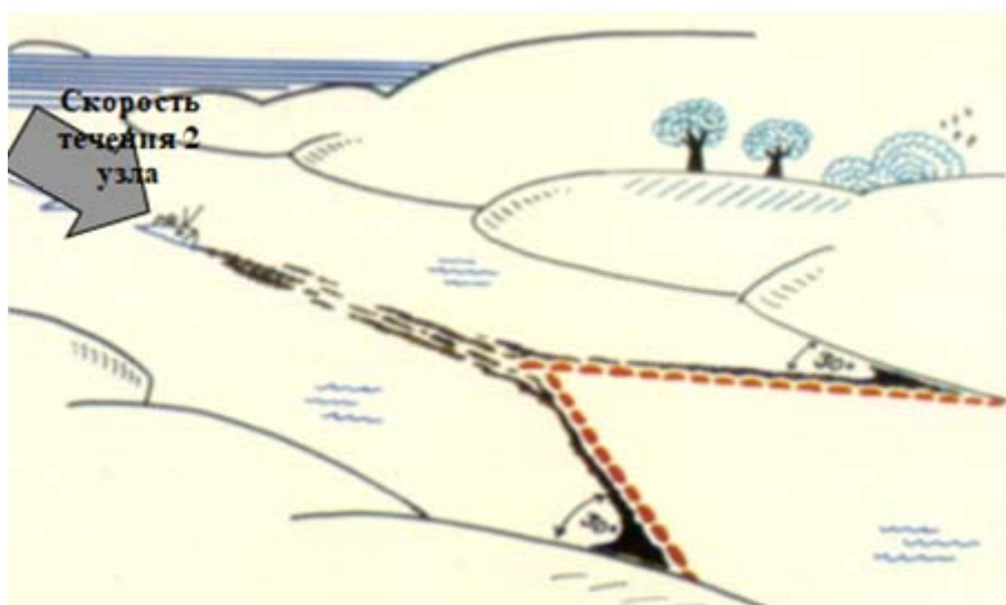
Рисунок Ж.14 Отклонение нефти в узкий проход между островами
