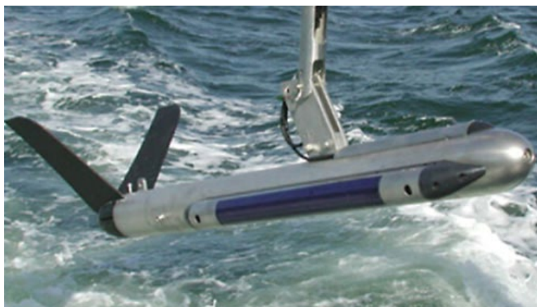
Рисунок 5.4-1. Внешний вид гидролокатора Klein 3000
