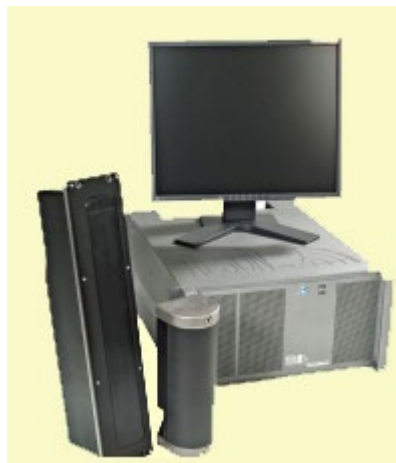
Рисунок 5.4-2. Внешний вид комплекса МПЭ Seabat 7125
