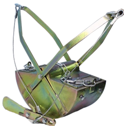
Дночерпатель Ван-Вина и сито для промывки грунта
