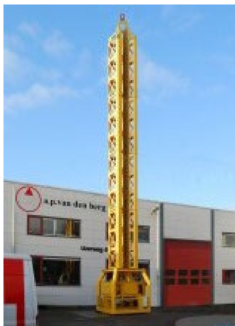
Рисунок 2.2-2. Установка статического зондирования Deep Water Roson 75/100kN
