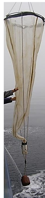
Ихтиопланктонная сеть типа ИКС-80
