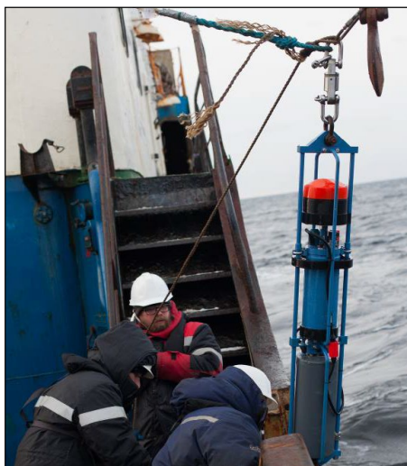
Рисунок 5.6-6. Постановка АБС с акустическим доплеровским профилографом течений RDCP 600 SW
