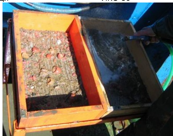
Дночерпатель Ван-Вина и сито для промывки грунта
