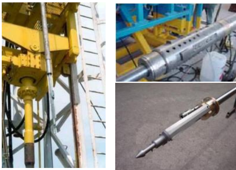
Рисунок 2.2-1. Комплекс внутрискважинного зондирования Wison-APB
