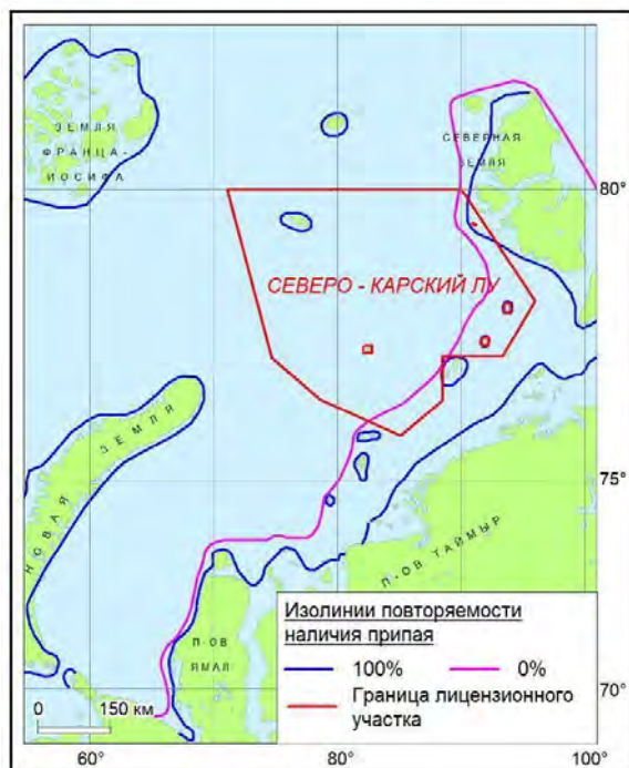
Рисунок 7.2-4. Характерное положение изолиний 100% и 0% повторяемости наличия припая при его наибольшей ширине в конце зимы (Спичкин, 2006)
