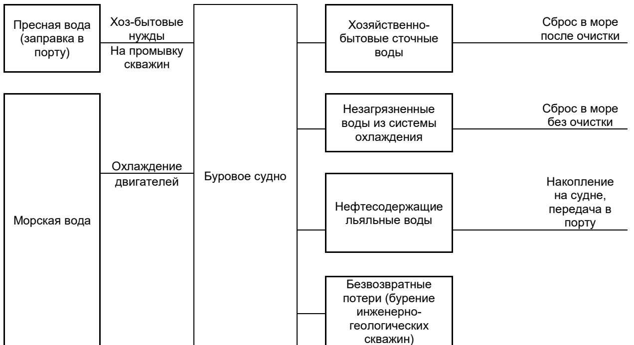
Рисунок 8.2-2. Схема баланса водопотребления-водоотведения на геотехническом судне
