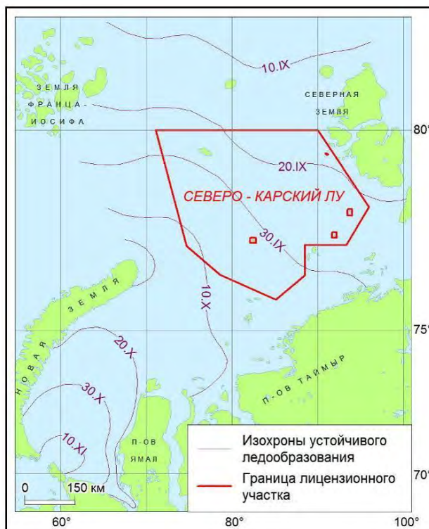
Рисунок 7.2-3. Среднемноголетнее положение изохрон устойчивого ледообразования в Карском море (Егоров, 2006)
